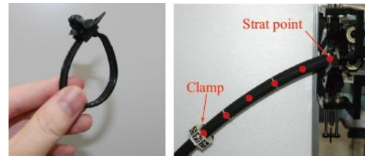
図 8. コムホースに結束バンドを付けることで実際のワイヤーハーネスの表面凹凸を表現した。（右の図にある赤い点に結束バンドが取り付けられている）
