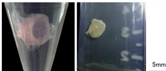
図9 バブルサイズおよび形成量によってコントロールされる組織担体(14日培養)
