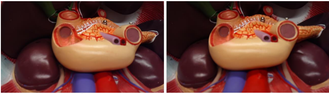
図4 開発した立体内視鏡で最小の輻輳角時の立体画像
