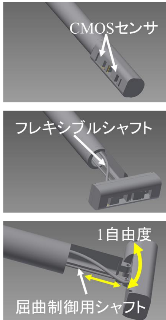
図1 屈曲機構と可変輻輳角機構を備えた立体内視鏡の設計
