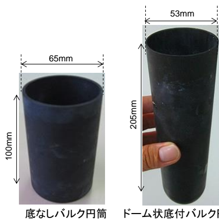
底なしバルク円筒 ドーム状底付バルク円筒 図7 高温超伝導 (HTS) バルク円筒 (左)、およびドーム状底付 HTS バルク円筒 (右)
