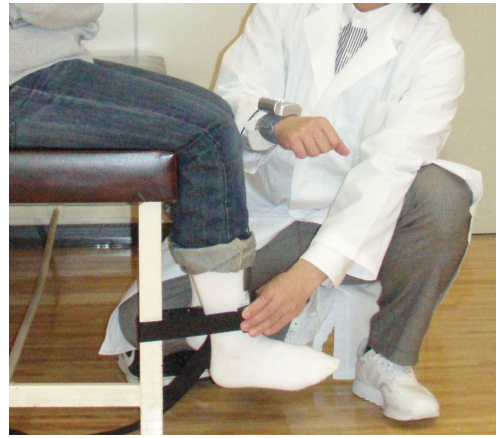
図1. 固定用ベルトを併用した徒手筋力測定装置による等尺性膝伸展筋力の測定
