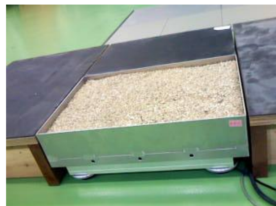
作成した砂場床反力計
