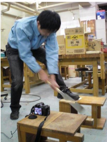
図1 ハイスピードカメラによるのこぎりびきの撮影
