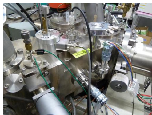
図 1. ビーム輸送系を改良した帯電液滴ビーム発生装置。中央部の内部に対物レンズと八極のビーム偏向電極が設置されている。
