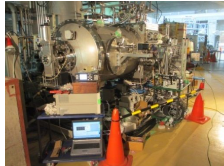
図5：Compact ERL 内に設置された主加速部超伝導空洞クライオモジュール。
