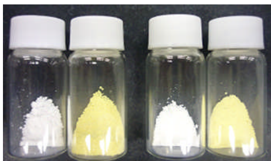
図 2 窒素ドーピングを行った \text{TiO}_2 の目視観察 (a) 未調整 P-25, (b) 窒素ドーピング P-25, (c) 未調整 ST-01, (d) 窒素ドーピング ST-01
