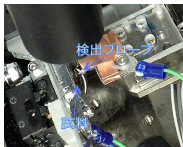
図 3 「近接場光照明-近接場光検出」のための検出プローブ走査システム
