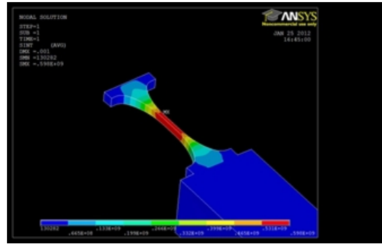
図4 試験片及び可動部の応力分布解析
