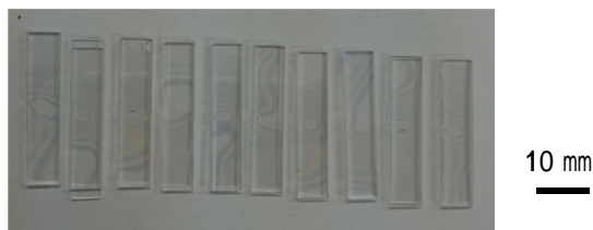
図 6 新方式を用いた超短光パルスマイクロ接合の結果。
