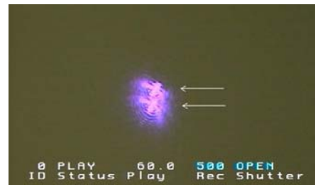
図6 複数液滴が同時に懸垂されている様子
