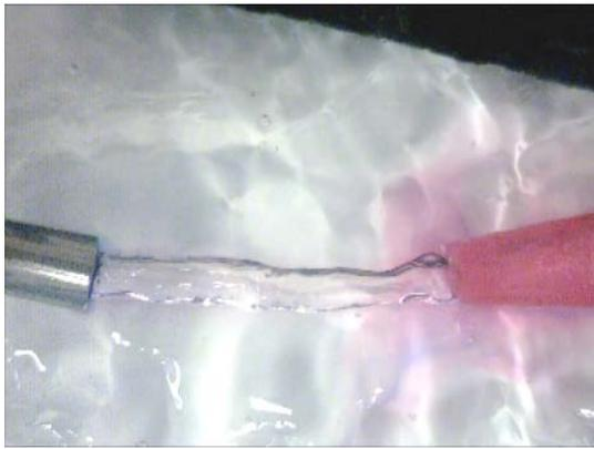
図-4 人工血管の流路確認
