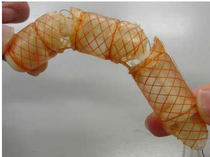
図5 試作した剛性可変フィンガ
