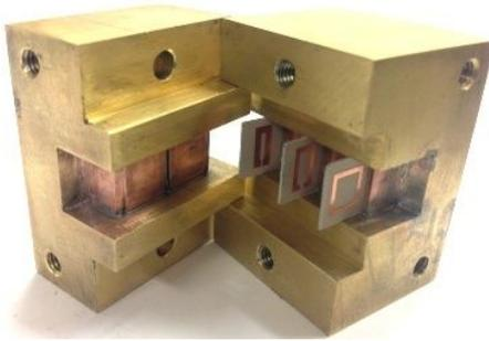
図4 試作した遮断導波管フィルタ
