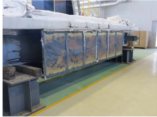
写真-3 加熱試験終了時の状況
