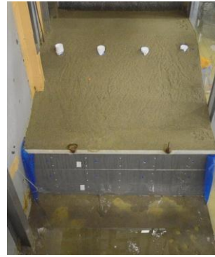
図-4 提案対策を施した模型盛土の降雨浸透実験後の状況
