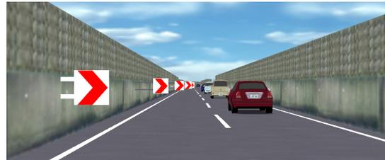
図6 可変バリアーの設定 (左車線閉鎖時の例)
