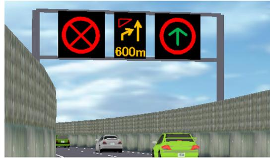
図5 可変情報板の設定 (左車線閉鎖時の例)
