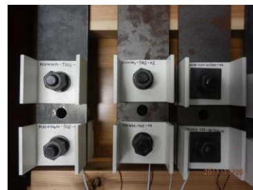
図 3 ボルト張力計測の様子
