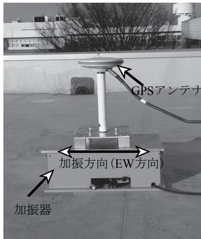
写真 1 加振器に設置された計測点
