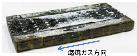
図5 燃焼試験後の試験片
