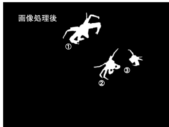
図5 色情報を用いた、海底画像からの底生生物(ベニズワイガニ)の領域抽出
