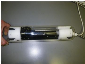
図1 ライゾトロン用チューブと開発した可視 近赤外デジタルカメラ。
