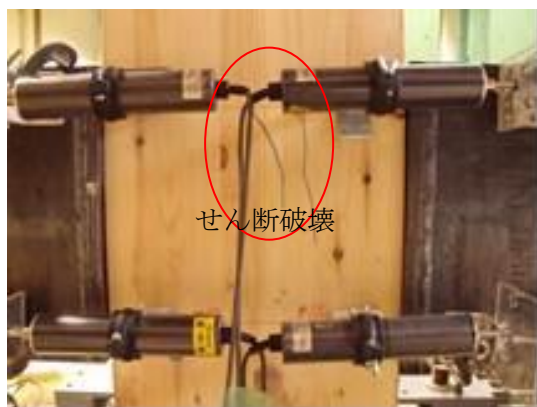
図2 柱-梁接合部における柱のパネルゾーンのせん断破壊
