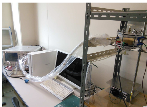
写真 1 20GHz 帯 TDT 計測システム
