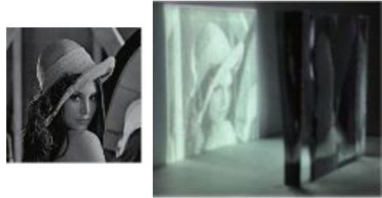
図 6. 二つ目の方法で, 棒を並べ方場合に生成できる他の集光模様の例. 上段: 入力集光模様. 下段: 投射された模様. 右の二例では, カラーフィルタを適用して色つきの集光模様を投射している.
