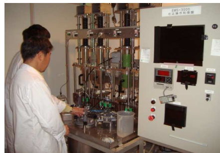
図 1. 原子核乾板の独自製造装置
