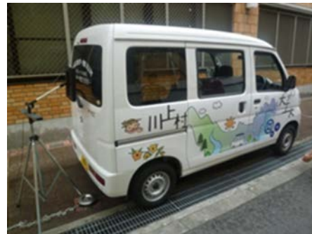
図9 実証用非接触EV充電システムおよび電気自動車
