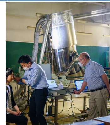
図2 脳磁計による神経活動の計測 高温超伝導自己シールド脳磁計 (住友重機械工業社製、東京電機大学に設置されている) を使用した計測の様子
