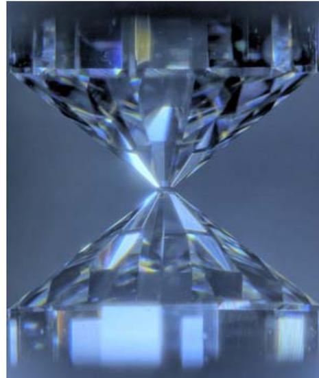
図1. ダイヤモンドセル超高压発生装置
