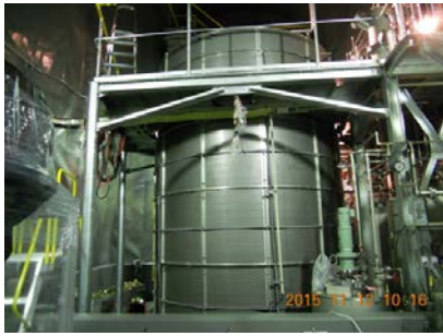
図3：鉛とBシートからなる遮蔽システム構築後のCANDLES III
