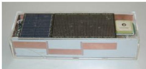
図1. 技術基準適合認定を頂いた端末（子局）マルチキャスト通信（多対多通信）
