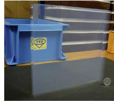
図 3 . 新しい製法で製作された高透明度のシリカエアロゲル
