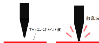
図2: 金属探針によるエバネセント波の散乱 (a)針位置が高く散乱なし (b)散乱波が生成
