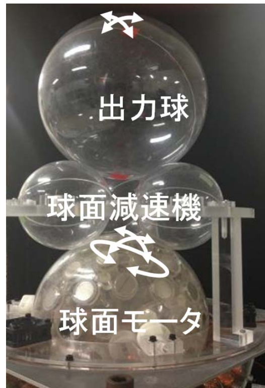
図 10 球面減速機の原理モデル
