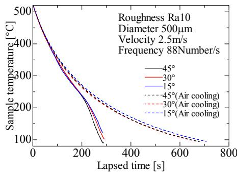
図 9 冷却曲線 (Ra10)
