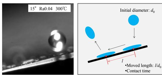
図 10 高温面衝突時の液滴の挙動
