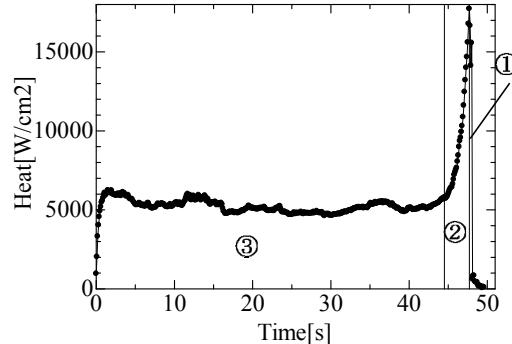
図6 蒸発時の全熱流束（基板温度100°C）
