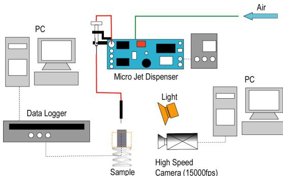
図3 衝突液滴群蒸発試験装置
