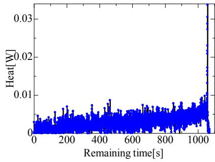
図5 非加熱基板上の水滴の蒸発過程
