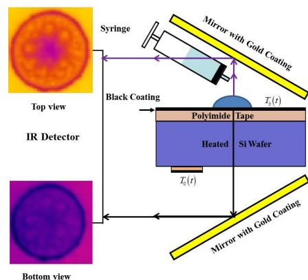
図2 シリコン基板を通じた赤外画像計測
