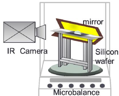
図1 赤外カメラおよび電子天秤による液滴蒸発過程の観察
