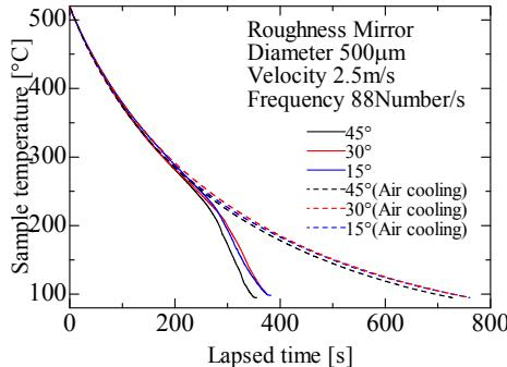
図 8 冷却曲線（鏡面）
