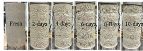
写真2 酸性水中の時間経過に伴う材料劣化(人工軟岩、pH4)
