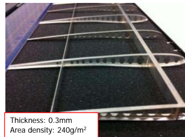
図 4 マグネシウムの削り出し加工による主翼構造の試作
