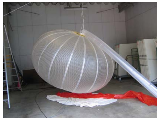
図1 網をかぶせた小型気球の膨張試験
