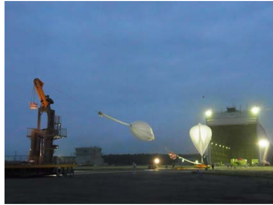
図 3 : 体積 3,000\text{ m}^3 の SP 気球の飛翔試験
