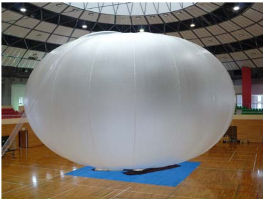
図 2 : 体積 2,000\text{ m}^3 の SP 気球の膨張試験
