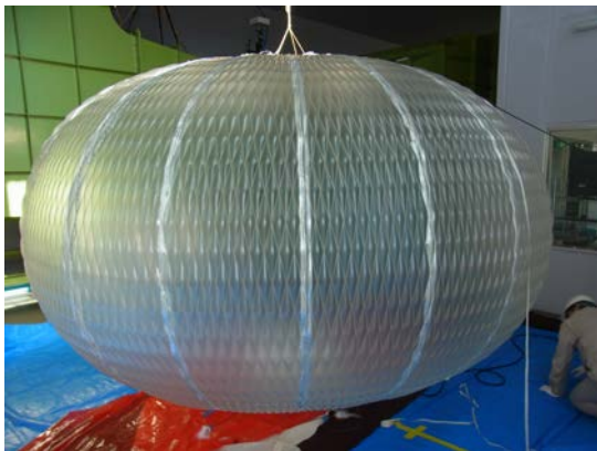
図 6: 体積 10 m 3 の SP 気球の膨張試験
