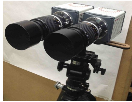
図1 開発した O_2A デュアルカメラシステム
