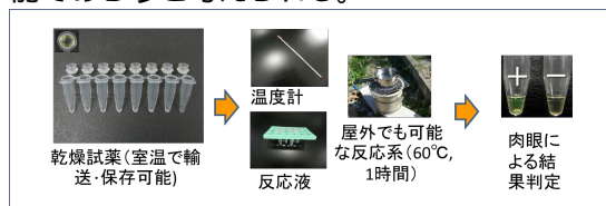
図1. 屋外でも可能な究極的LAMP法
