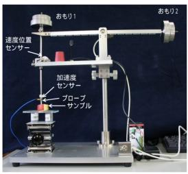
天秤型装置では水平アームの両端に錘1 と2を取り付けた。錘1の下には垂直に棒を 取り付けその先端に楔形のプローブを取り 付けた。楔形のプローブと棒の間に加速度セ ンサーを挟み、プローブの振動を検出した。 錘1と垂直棒及びセンサーなどの総重量が錘 2 の重量より大きくなるようにしておき、錘 2 を下げて手を放すと錘1及びプローブが下 降し、サンプルに突き刺さる。
