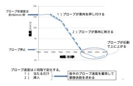
天秤型のプローブを果実の果肉などのサ ンプルに挿入すると、上図のような速度変化 をすることが分かった。縦軸がプローブ速度 で、横軸は経過時間である。この例では、プ ローブの初速度は約160ミリ/秒であった。プ ローブはサンプルに挿入されたのち止まる が、実際は速度が0になるのではなく、反動 で上昇するので、速度がマイナスを取る。経 過時間 1980 ミリ秒以降はこの状態を示して いる。完全にプローブが停止すると、プロー ブ速度は0となる。この図からプローブ速度 が減少するパターンが2つに分かれることが 分かった。前半と後半である。前半はプロー ブが果肉に刺さるのではなく、押すだけで、 実際にプローブが刺さるのはそのあとであ ることが振動データから推測された。しかし、 いずれにしてもプローブの初速度が決定で きたので、プローブの運動エネルギーを確定 することができた。
