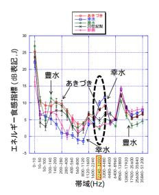
縦軸はエネルギー食感指標で、振動強度が高いほど大きな値を示す。横軸は帯域で、左は低い振動帯域を右は高い振動帯域を示す。この図から読み取れることは、軟らかい豊水は低い振動数の強度が高く、幸水は高い振動数の強度が高いということである。しかしほかの品種の特徴はよくわからない。
