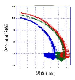
サンプルはリンゴ('フジ')、ナシ('ニ 十世紀 ')、カキ(' 冨有')である。この図で は、速度位置センサーでとらえられたプロー ブの速度の変化と位置の変化をそれぞれY 軸とX軸にとった図を示している。このグラ フではリンゴ ('フジ'), カキ ('富有') 及 びナシ('二十世紀')の結果を示した。プロ ーブの挿入初速度はおおよそ 150~175mm/ 秒であった。プローブの侵入深さが増すにつ れて、プローブの速度が減少する様子が詳細 に測定できた。グラフで速度がマイナスにな る場合があるが、これはプローブが最も深い 位置に到達した(速度0)のちに、反動で上 昇することを示している。挿入深度は,6ミ リから4ミリであった。侵入深さが少ないの は硬い果肉であることを示す。二十世紀は 'フジ'や'富有'に比べて果肉が硬いこと を示している。
