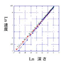
この図からY軸の切片を決定し、プローブにかかる全質量をかけると摩擦係数が求まる。
