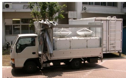
図1. トラックに搭載された千葉大ミリ波雲レーダFALCON-I。周波数95GHzで、淡い雲も観測できる高感度と、角度分解能 0.2^\circ の高解像度を有している。直径1mのアンテナ2台の左で電波を真上に送信し、雲で散乱して戻ってきた電波を右のアンテナで受信して鉛直プロファイルを得る。
