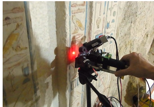
図 5 開発した分光計による壁画顔料のオンサイト分析の様子
