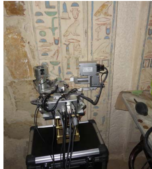
図 4 開発した粉末回折計により、古王国の壁画の顔料を分析している様子
