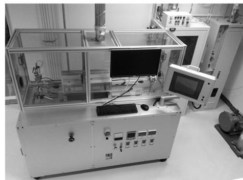
図 1 SiNW 気相成長専用 VLS-CVD 装置
