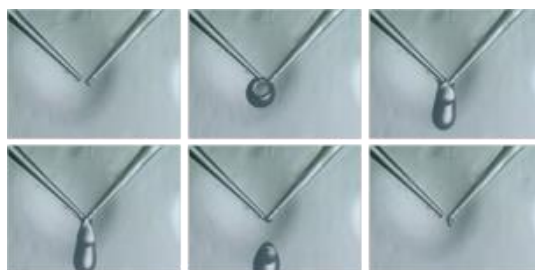
図 5 2層エマルジョン(カプセル)の生成実験
