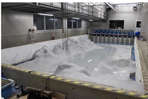
図1 大型水槽による瓦礫流動実験
