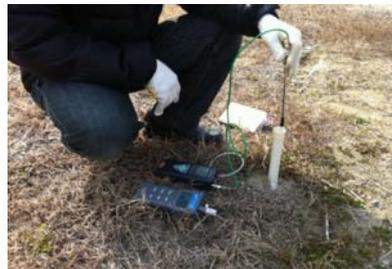
図6 ガスサンプリングと濃度測定の様相
