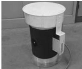
図12 本研究で開発したCO<sub>2</sub>モニター装置のプロトタイプ
